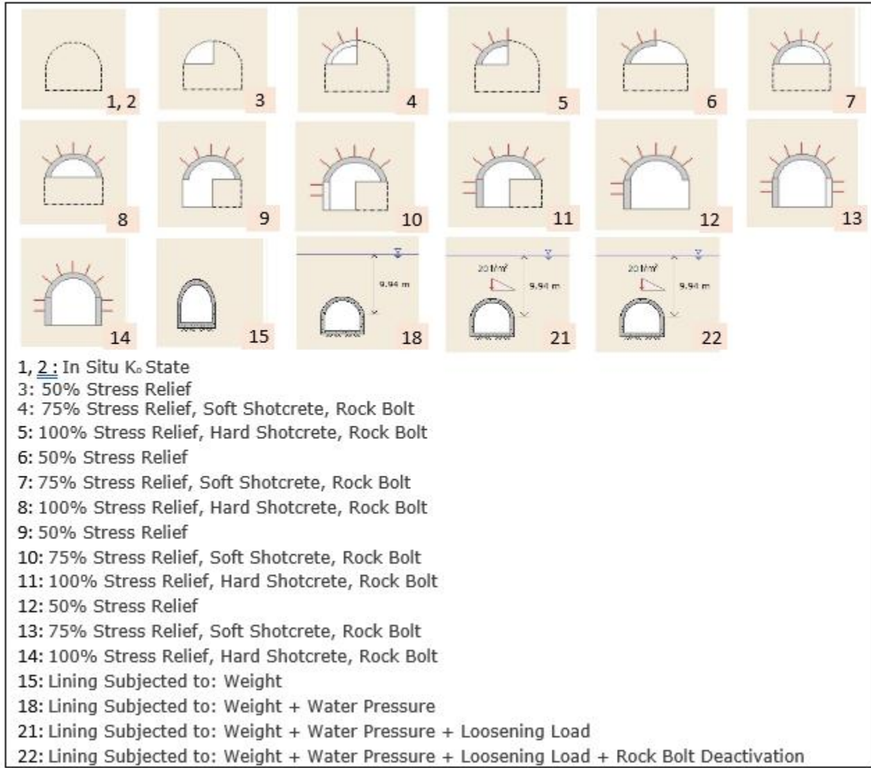
Şekil 2. Tasarlanan tünelin kazı adımları
