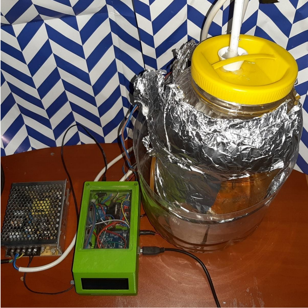
Şekil 0.12 Paslandırma ünitesi son hali
